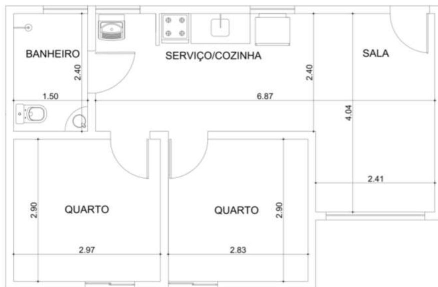
FIGURA 1: Planta baixa de uma unidade unifamiliar do Conjunto Habitacional Padre José Edwaldo Gomes, à rua Lemos Tôres, 49 - Casa Forte, Recife – PE.
